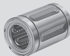
**Сегментные шариковые втулки** с прочным пластмассовым корпусом отличаются особой экономичностью и готовностью к установке. Для работы в коррозионной среде или в условиях повышенной чистоты, например, в пищевой, полупроводниковой или медицинской промышленности, данные шариковые втулки поставляются в нержавеющей стали.
