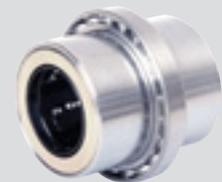
**Линейные устройства** представляют собой завершенный опорный узел, состоящий из корпуса с одной или двумя шариковыми втулками Rexroth. Их поставка возможна в нескольких исполнениях. Благодаря экономичному изготовлению линейные устройства отличаются выгодной ценой по сравнению со втулками обычного исполнения. Корпуса легко собираются во время монтажа, исключая любую деформацию шариковых втулок.
