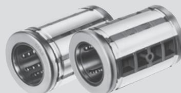
**В радиальных шариковых втулках** шарики поворачиваются наружу. Большое количество длинных, несущих шариковых рядов обеспечивает высокую жесткость втулок, благодаря чему они могут использоваться в качестве линейных подшипников в специальных машинах, работающих с еще большими нагрузками.
