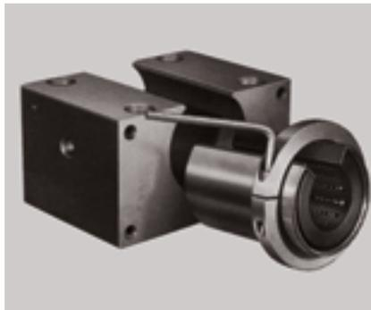
Установить на шариковую втулку монтажное кольцо<sup>1)</sup> с разрезом (номер для заказа R0940-0..-00), как показано на иллюстрации, и уменьшить наружный диаметр шариковой втулки при помощи затягивания регулировочного винта таким образом, чтобы втулка легко входила в отверстие корпуса "от руки". Отверстие монтажного кольца должно быть примерно на 0,5 mm больше наружного диаметра D радиальной шариковой втулки.
