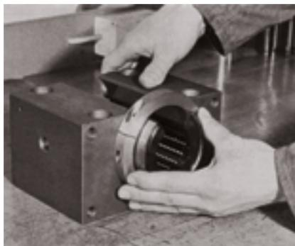
После установки радиальной шариковой втулки в корпус, но до отпускания монтажного кольца, необходимо совместить отверстие радиальной шариковой втулки с отверстием в корпусе. Теперь можно отпустить монтажное кольцо.
