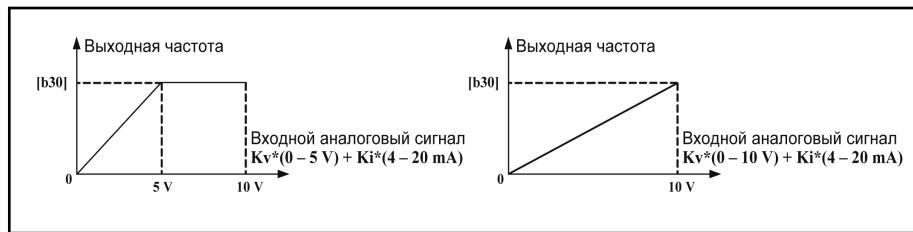
Рис. 7-3: Комбинация ввода клеммы VRC и клеммы +/-
