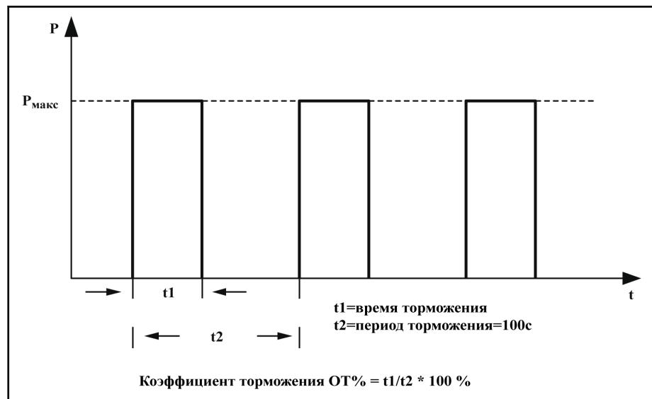
Рис. 10-14: Тормозной коэффициент
